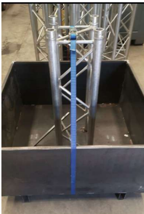
1. Estructura preparada per al formigonat.
